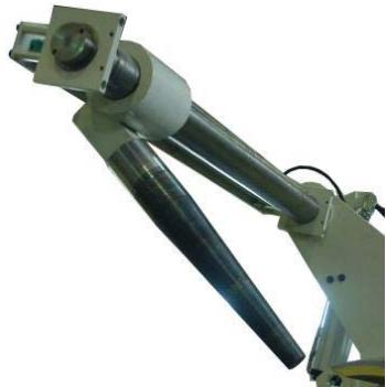
**CONI DI CONTENIMENTO LATERALE DEL COIL,** sostituendo le baionette, riducono i tempi di cambio del coil e permettono di poter utilizzare bracci larghi anche con coil stretti. La traslazione per adeguarsi alle diverse larghezze del coil e la rotazione degli stessi è motorizzata e comandata dal pulpito principale.
