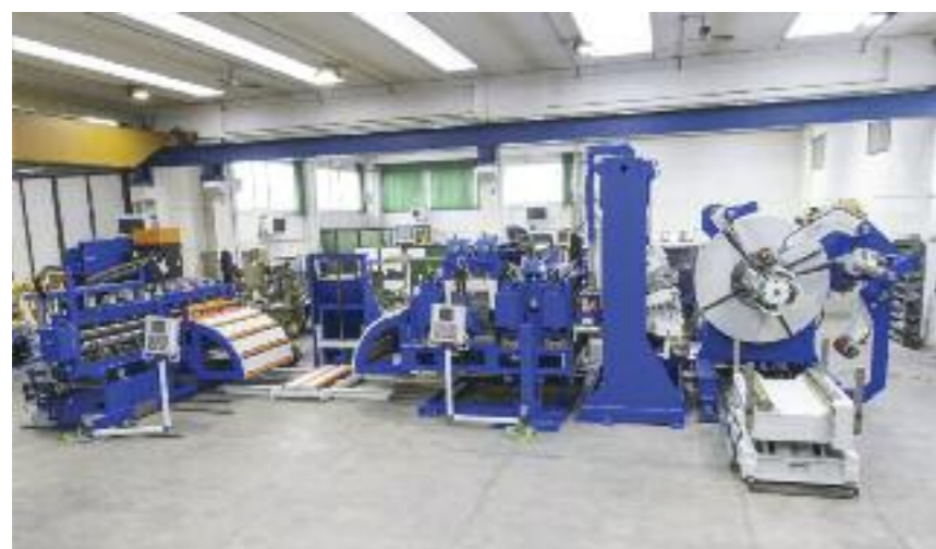
Impianto per servopressa: larghezza 1500 x 12 mm di spessore
