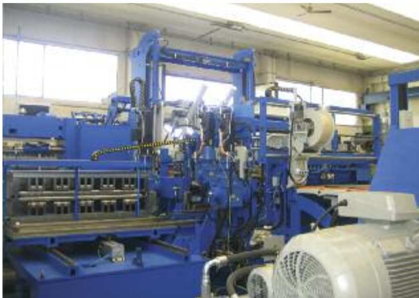
Impianto per servo-presse da 2.500 t
